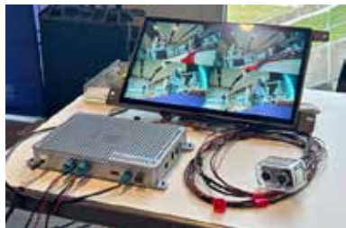
Bild 1: Multi-Kamera-Demo von Hinge Technology mit KDs KD7251, optischen 10-Gbit/s-Links und optischem Backbone
