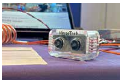
Bild 2: Optische Automotive-Kamera von Hinge Technology auf Basis von KDs KD7251 für die Datenübertragung mit 10 Gbit/s
