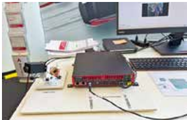
Bild 1: Demoaufbau: ein VN5650 mit integrierten optischen KD7251-PHYs von KD mit seinen optischen Steckverbindern. In diesem Aufbau sind die PHYs im Loopback geschaltet, um Gigabit-Kameradaten live zu übertragen.
