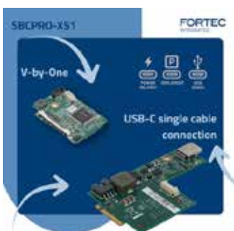
Bild 2: SBCPRO-X51 mit flexiblen M.2-Modulen für V-by-One und USB-C für Strom, DisplayPort und Touch
