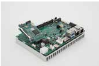
Bild 1: SBCPRO-X51 von FORTEC: flexibler 3,5"-SBC mit Intel® Amston Lake für anspruchsvolle Projekte
