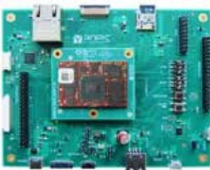
Bild 3: Evaluation Board MSRZG3EEVK von ARIES Embedded mit Renesas RZ/G3E MPU für Rapid Prototyping und schnellen Projektstart
