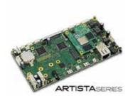
Die neue IIoT-Plattform Artista M4 von Distec steuert hochauflösende Display-Anwendungen mit V-by-One an
