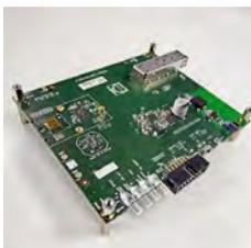
Bild 2: Evaluierungsboard im Evaluierungskit EVK9351AUT für 1000BASE-RHC Automotive Bridge
