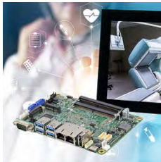
Bild 1: Robuster Single-Board-Computer IB918 von iBASE mit AMD® Ryzen™ V1000 für Industrieinsatz jetzt bei Distec
