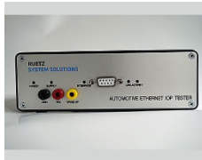
Bild 1: IOP-Tester von RUETZ SYSTEM SOLUTIONS prüft Steuergeräte auf Interoperabilität
