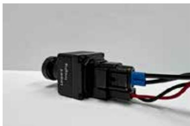
Imagen 1: Leopard Imaging implementó el transceptor KD7251 de KD en la cámara para automóviles LI-VENUS-ISX031-BASE-AU con el conector híbrido y harness de calidad para automóviles de Corning.
