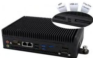
Imagen 1: BoxPC Pro NPA-2009 de Distec con interfaz V-by-One y eDP
