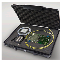
图片 1 : KDPOF 的广泛评估套件 EVK9351AUT 简化了光千兆连接的项目启动工作
